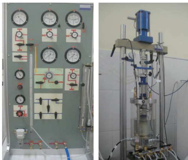
Hình 1: hệ thống thiết bị thí nghiệm 3 trục động DTC - 367D
