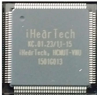
Hình 13: chip iHearTech được chế tạo hoàn chỉnh [14]
