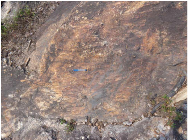
Hình 4: các cấu tạo đường trượt được bảo tồn khá tốt tại đền Hạ Mì (An Châu) là dấu hiệu của đứt gãy trượt bằng trái phát triển theo phương Tây Bắc - Đông Nam
