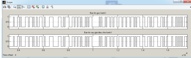
Hình 30: bản tin gốc ở phía phát và đầu ra sau giải điều chế QPSK ở phía thu
