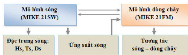
Hình 2: sơ đồ kết nối module sóng và dòng chảy trong mô hình MIKE 21/3 Coupled
