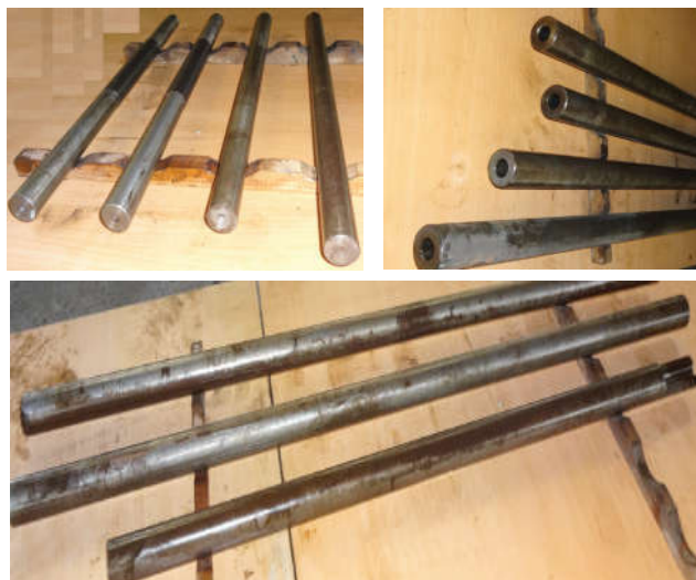
Hình 8: các lỗ khoan \Phi 5 , \Phi 14 và \Phi 22
