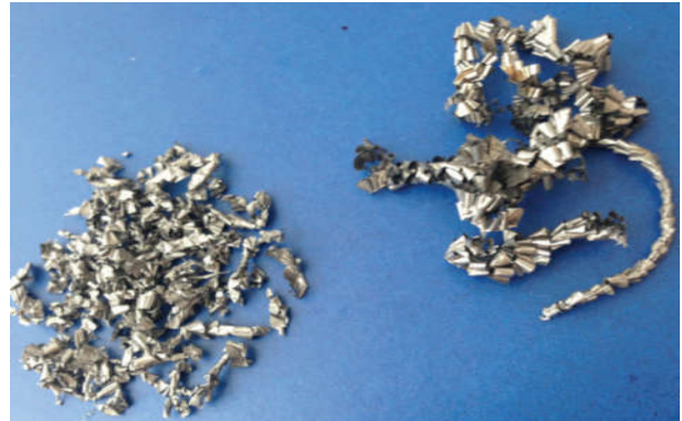
Hình 7: dạng phoi khoan khi khoan lỗ \Phi 14 ở các chế độ phoi mịn và phoi thô
