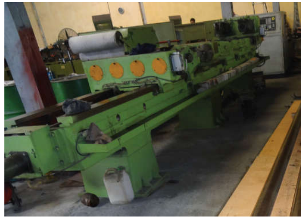
Hình 3: máy khoan lỗ sâu gundrill 4 trục
