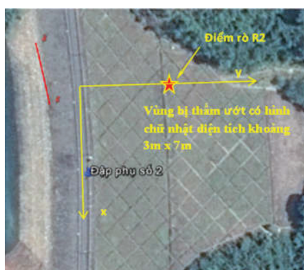
Hình 1. Hình chụp đập phụ số 2, điểm rò R2 (trái) và đập phụ số 3, điểm rò R3, R4 và R5 (phải).
