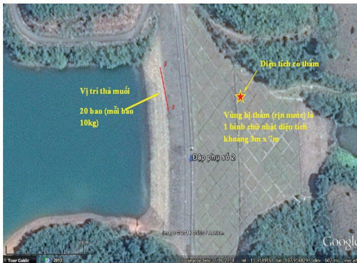
Hình 3. Bố trí thả chất đánh dấu liên thông ở đập phụ số 2 (trái) và đập phụ số 3 (phải).
