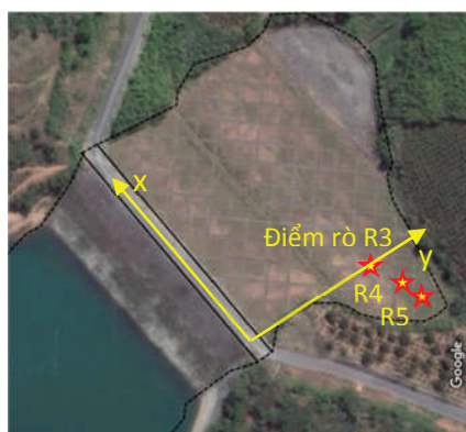
Hình 1. Hình chụp đập phụ số 2, điểm rò R2 (trái) và đập phụ số 3, điểm rò R3, R4 và R5 (phải).
