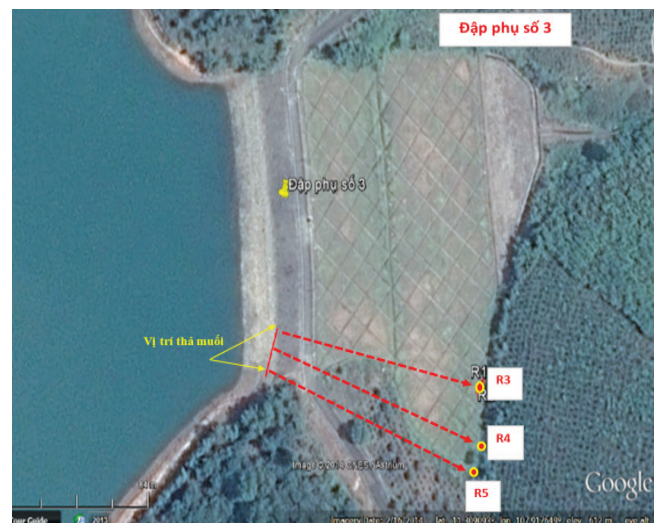
Hình 3. Bố trí thả chất đánh dấu liên thông ở đập phụ số 2 (trái) và đập phụ số 3 (phải).
