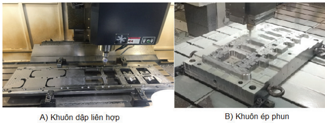
Hình 3. Khuôn dập liên hợp và khuôn ép phun trong quá trình gia công.
