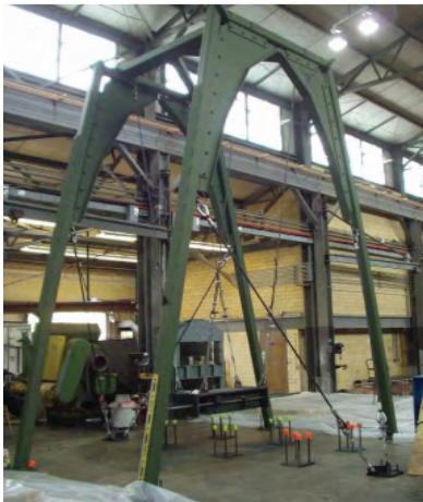
Hình 3. Mô hình va chạm bằng con lắc.
