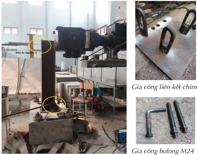
Hình 8. Bố trí mô hình thực nghiệm.
