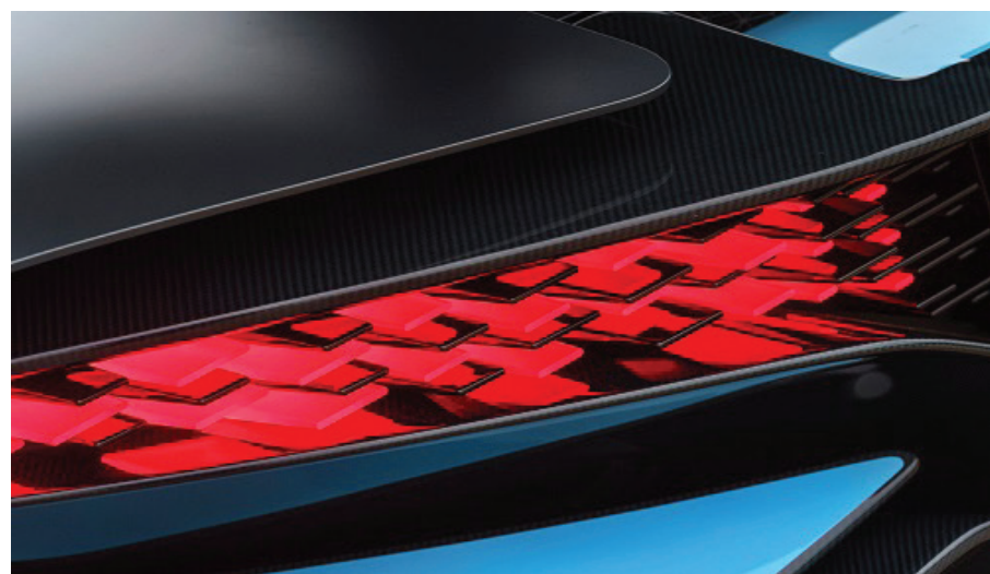
Đèn hậu dạng vây trên siêu xe Divo của Bugatti Automobiles SAS được sản xuất bằng công nghệ in 3D.
