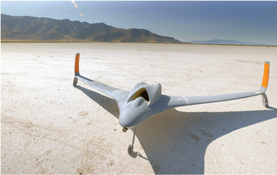
Máy bay không người lái của Aurora Flight Sciences được sản xuất bằng công nghệ in 3D.
