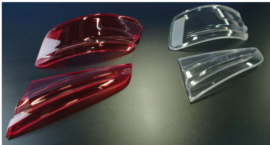
Vỏ đèn hậu của xe Audi được sản xuất bởi công nghệ in 3D.
