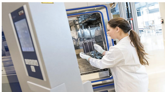
Một nhà nghiên cứu tại Đức, thử nghiệm một pin mặt trời có kích thước thương mại được chế tạo bằng cách xếp lớp perovskites trên silicon.
