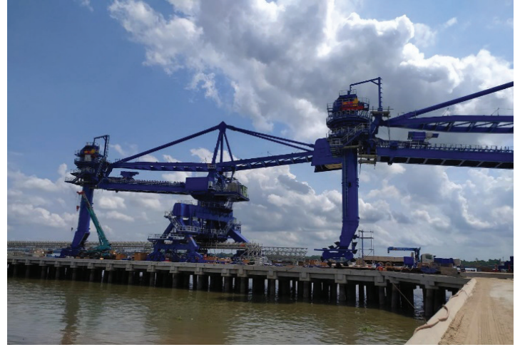
Hệ thống bốc dỡ, vận chuyển than tại Nhà máy Nhiệt điện Sông Hậu 1.
