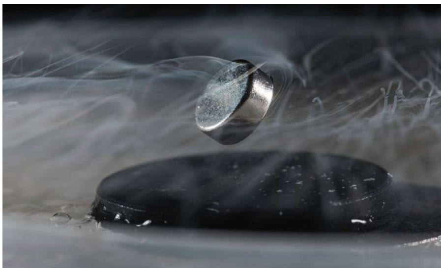
Khối vật thể siêu dẫn “lơ lửng” trong không gian theo hiệu ứng Meissner.
