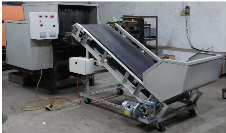
Hình 1. Máy tách vỏ dừa tự động có công suất 500-700 trái/giờ.
