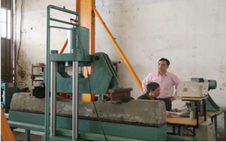
Thiết bị thử môi tà vệt do Viện Chuyên ngành Cơ khí, Tự động hóa, Đo lường nghiên cứu, chế tạo.
