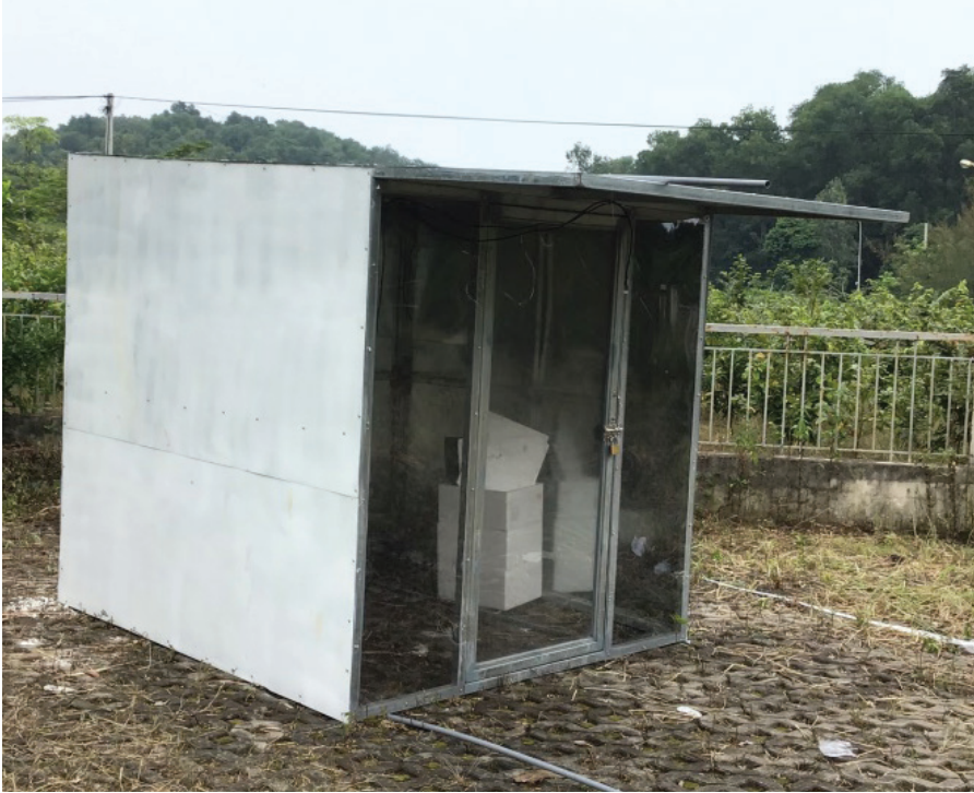
Mô hình nhà thép diện tích 2x2 m 2 được phủ sơn do nhóm nghiên cứu, sản xuất luôn giữ được nhiệt độ như không khí dưới bóng râm, kể cả giữa trưa.
