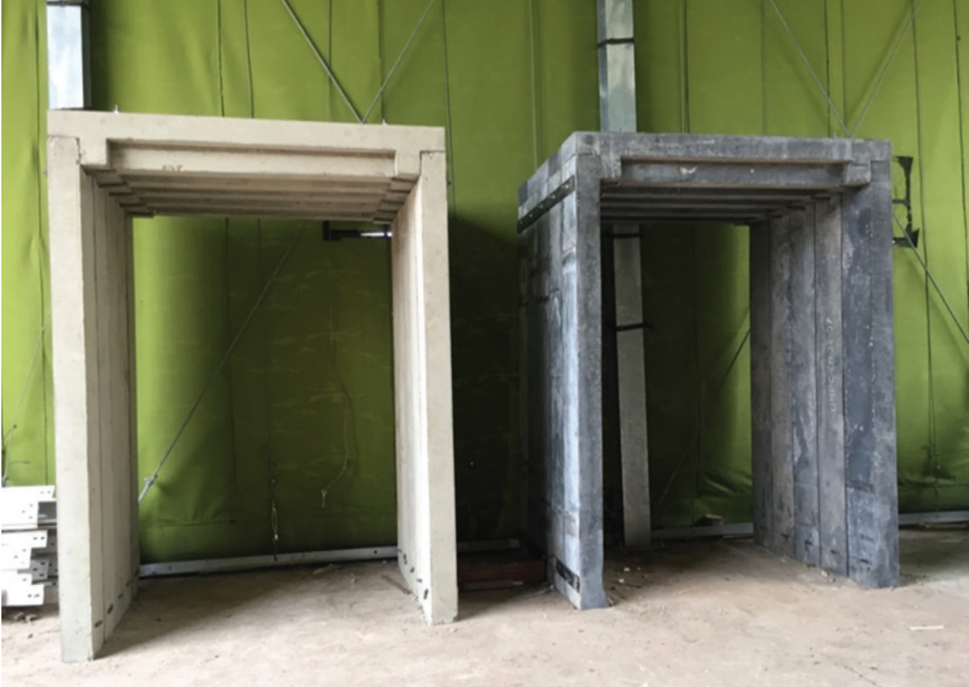
Mô hình công sự bằng UHPC (bên phải) và bằng bê tông thường (bên trái) phục vụ thử nghiệm thực tế tại hiện trường.
