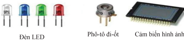
Hình 1. Các thành phần chính của hệ thống Li-Fi.
