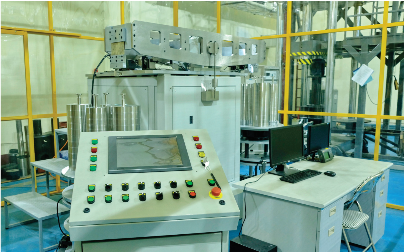
Máy chuẩn đầu mô men lực do Viện Đo lường Việt Nam nghiên cứu, chế tạo.
