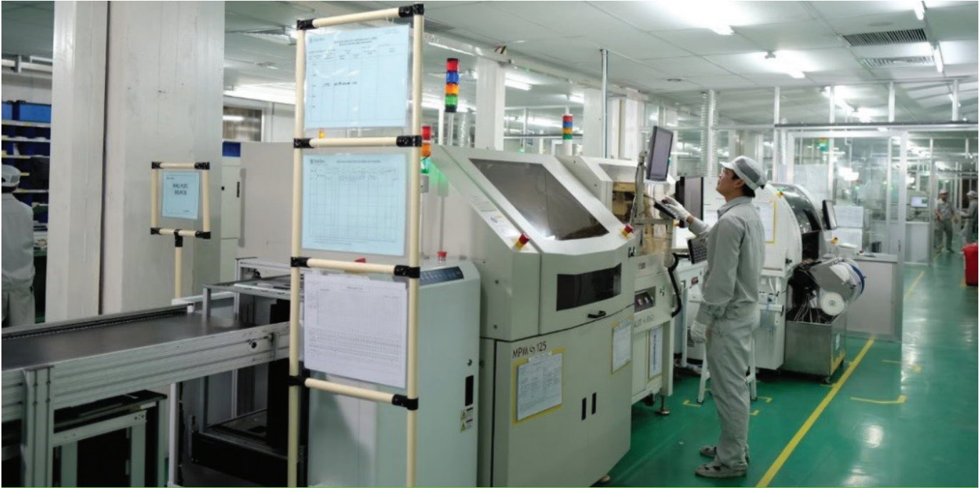
Dây chuyền sản xuất LED SMD tại Công ty Cổ phần Bóng đèn Phích nước Rạng Đông.
