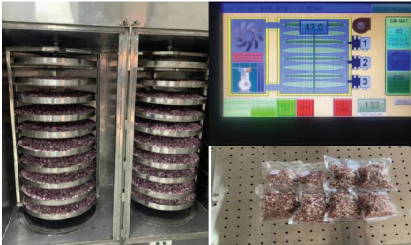
Hành tím thái lát được sấy trên thiết bị sấy bơm nhiệt kết hợp vi sóng tại Trung tâm Ứng dụng Tiến bộ Khoa học và Công nghệ (Sở Khoa học và Công nghệ Sóc Trăng).
