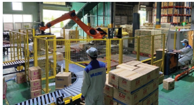
Dây chuyền đóng gói bột giặt tự động.
