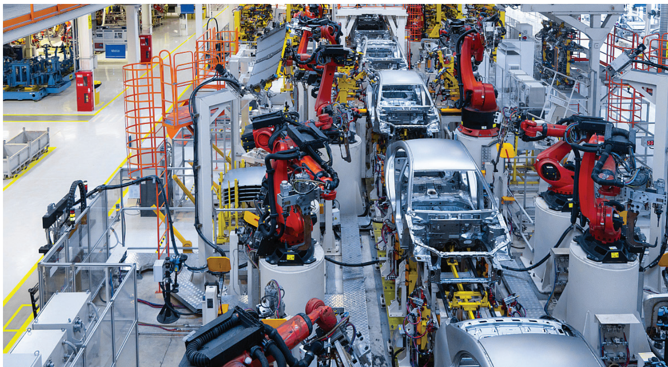
Lắp ráp ô tô sử dụng robot. Ảnh: ST.
