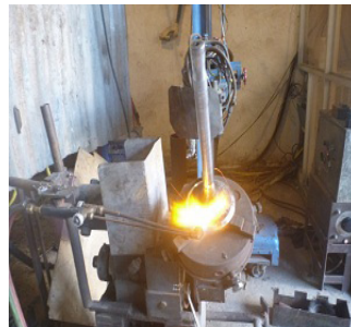
Quá trình gia nhiệt bề mặt xupap trước khi hàn
