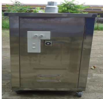
Hình 2: bếp gas hồng ngoại cải tiến nhìn từ các phía
