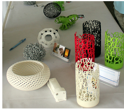
Những món quà lưu niệm được hãng Shapeways in ra bằng công nghệ 3D. Khách hàng có thể đặt hàng qua catalogue trực tuyến của Công ty hoặc tự biến ý tưởng của mình thành một file 3D trên chương trình máy tính và gửi file đến, Shapeways sẽ in ra sản phẩm và gửi cho khách hàng
