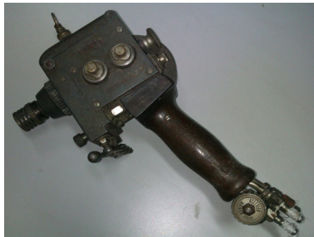
Hình 3: đầu phun dây bằng oxy - khí cháy
