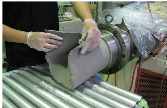
Hình 2: sản xuất tấm xi măng sợi mỏng bằng phương pháp đùn
