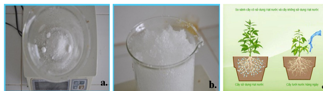
Hình 1: hình ảnh mô tả polyme siêu hấp thụ nước trước khi hấp thụ nước (a); sau khi hấp thụ nước (b) và mô tả quá trình giữ nước của AMS-1 cho cây trồng (c)
