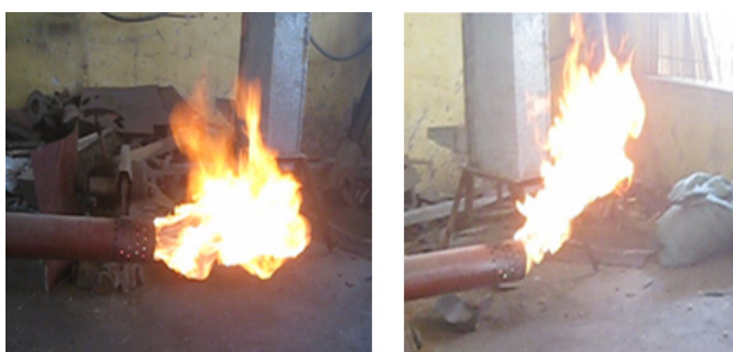
Hình 3: chiều dài và cường độ ngọn lửa của lò khí hóa lõi ngô
