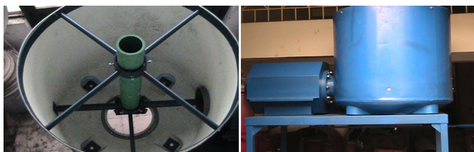
Hình 7: phần cơ của hệ thiết bị đo gồm hộp chứa nguồn và thùng đo mẫu
