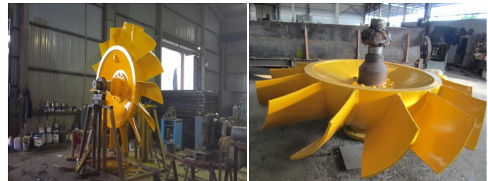
Hình 3: cụm bánh quay sau khi phục hồi
