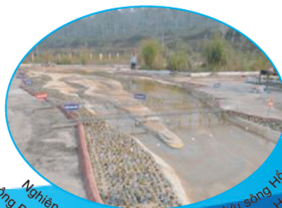
Mô hình đập chắn sóng - cảng lọc dầu Nghi Sơn được mô phỏng trong bể thí nghiệm sóng triều
