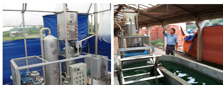
(a) Hình 1: HMĐXLKT quy mô pilot tại Cổ Nhuế (a) và Nhà máy gạch tuynel Đan Phượng, Hà Nội (b) 1- Lò đốt than; 2 - Modul khử bụi; 3- Modul hấp phụ - xúc tác; 4 - Modul phun sương; 5 - Thiết bị nạp CO 2 cao áp; 6 - Panel điều khiển hệ
