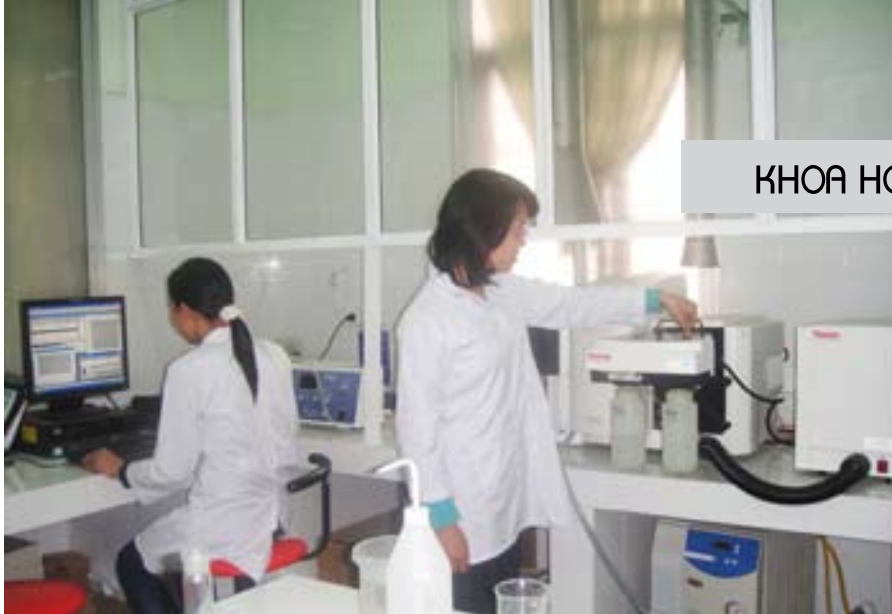
Phân tích kim loại nặng bằng thiết bị quang phổ hấp thụ nguyên tử (ASS-GF)
