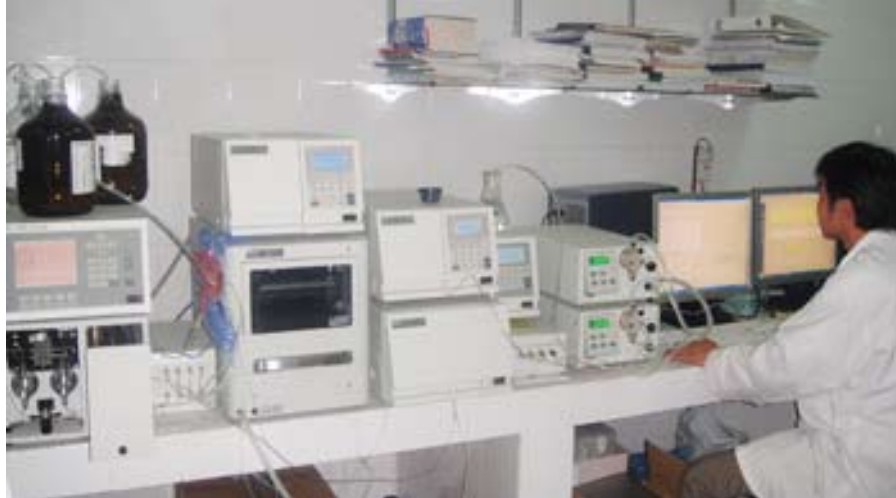
Phân tích dư lượng thuốc bảo vệ thực vật bằng thiết bị sắc khí phối khối (GC-MS), sắc ký khí (GC) và sắc ký lỏng cao áp (HPLC)
