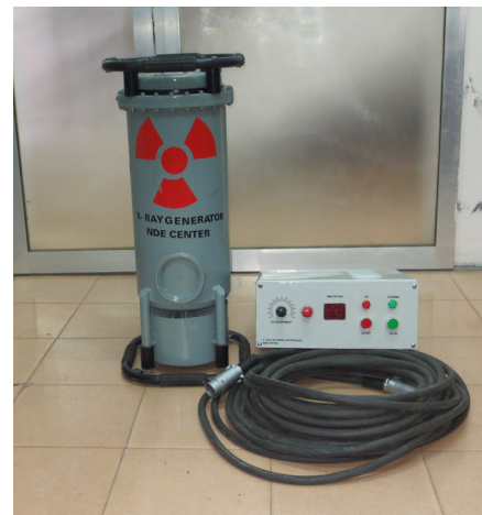
Hình 5: máy phát tia X hoàn chỉnh
