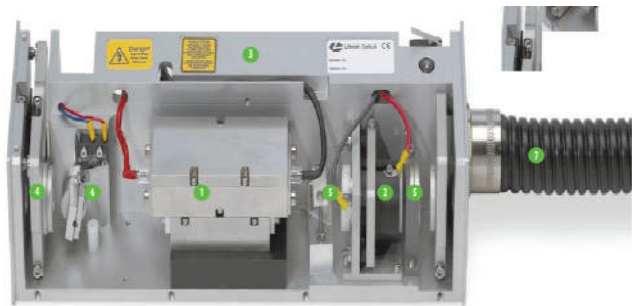
Hình 2: Laser Litron Nano S 120-20 1. Buồng bơm; 2. Tế bào pockels; 3. Buồng cộng hưởng; 4. Gương thoát laser; 5. Bản bước sóng và kính phân cực; 6. Van an toàn điện; 7. Cáp nguồn nuôi
