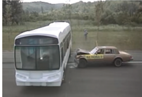
Hình 4: thử nghiệm va chạm giữa thân xe bus composite và xe Ford
