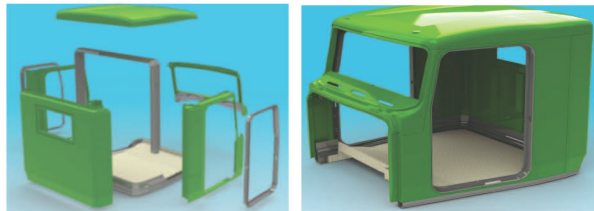
Hình 2: các mảng rời và cabin xe tải bằng vật liệu composite
