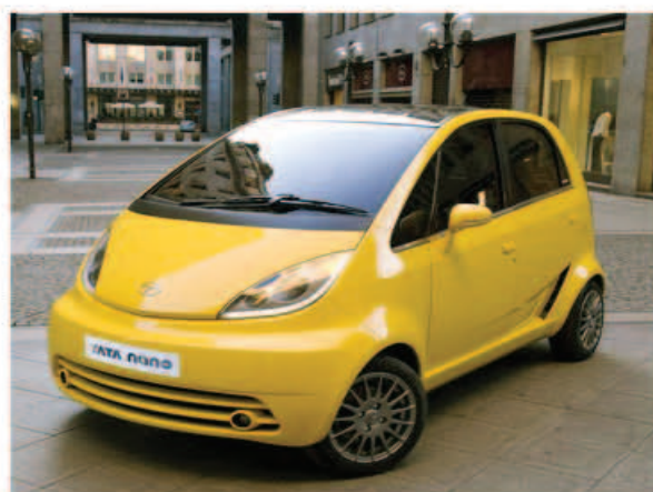
Hình 1: xe Tata Nano của hãng Tata Motors (Ấn Độ) với thân vỏ làm bằng vật liệu composite sợi thủy tinh
