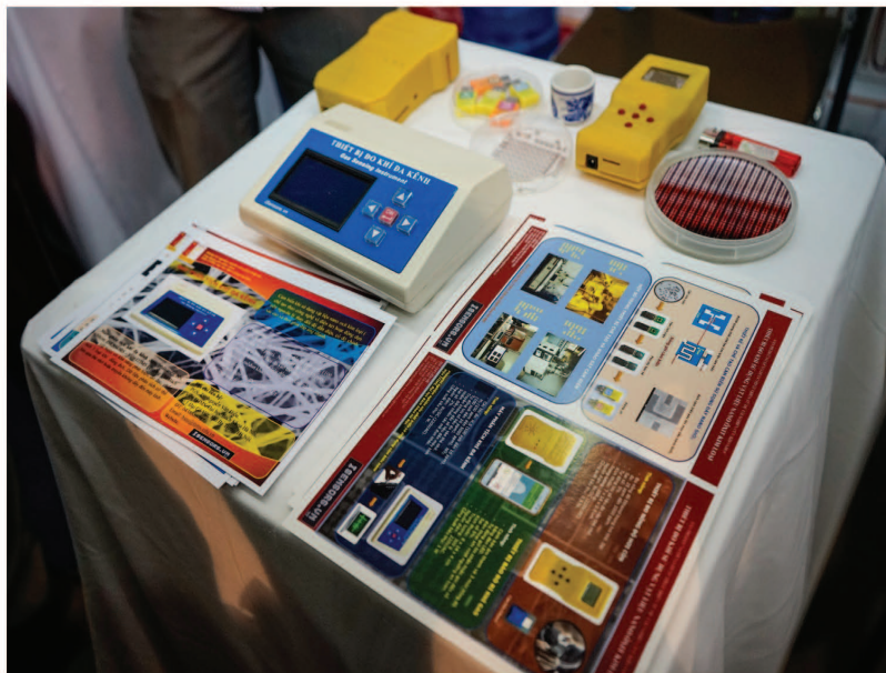
Nhóm thiết bị đo khí sử dụng vật liệu nano oxit kim loại do ITIMS nghiên cứu phát triển với nhiều ứng dụng như đo nồng độ cồn, cảnh báo rò rỉ khí ga... hứa hẹn sẽ được triển khai rộng rãi trong thời gian tới
