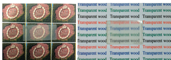
Hình 3: ảnh minh họa sản phẩm gỗ trong suốt với bề dày 1,2 mm đặt trên nền chữ
