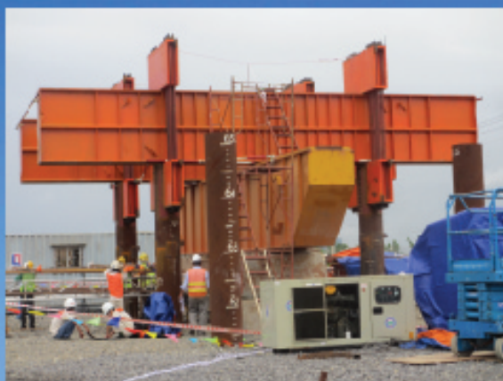
Công nghệ thủ lĩnh cọc sử dụng các cảm biến đo biến dạng dọc theo thân cọc
