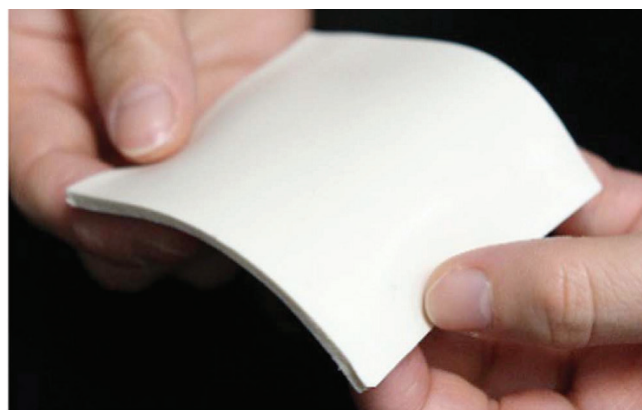
Hình 5: tấm mỏng polymer fluorenoneol được hình thành sau quá trình hydro hóa polymer fluorenone
