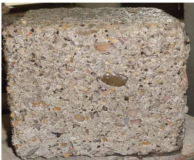
Mẫu bê tông với 20% vụn cao su trong thành phần phối liệu
