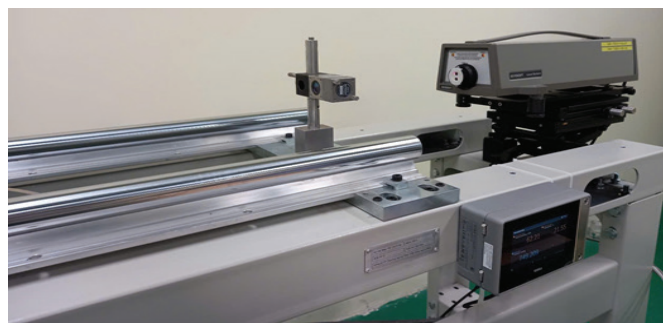
Hệ thống thiết bị hiệu chuẩn/kiểm định thước vạch, thước cuộn phạm vi đo đến 30 m do Viện Đo lường Việt Nam nghiên cứu, chế tạo. Ảnh: NNH.
