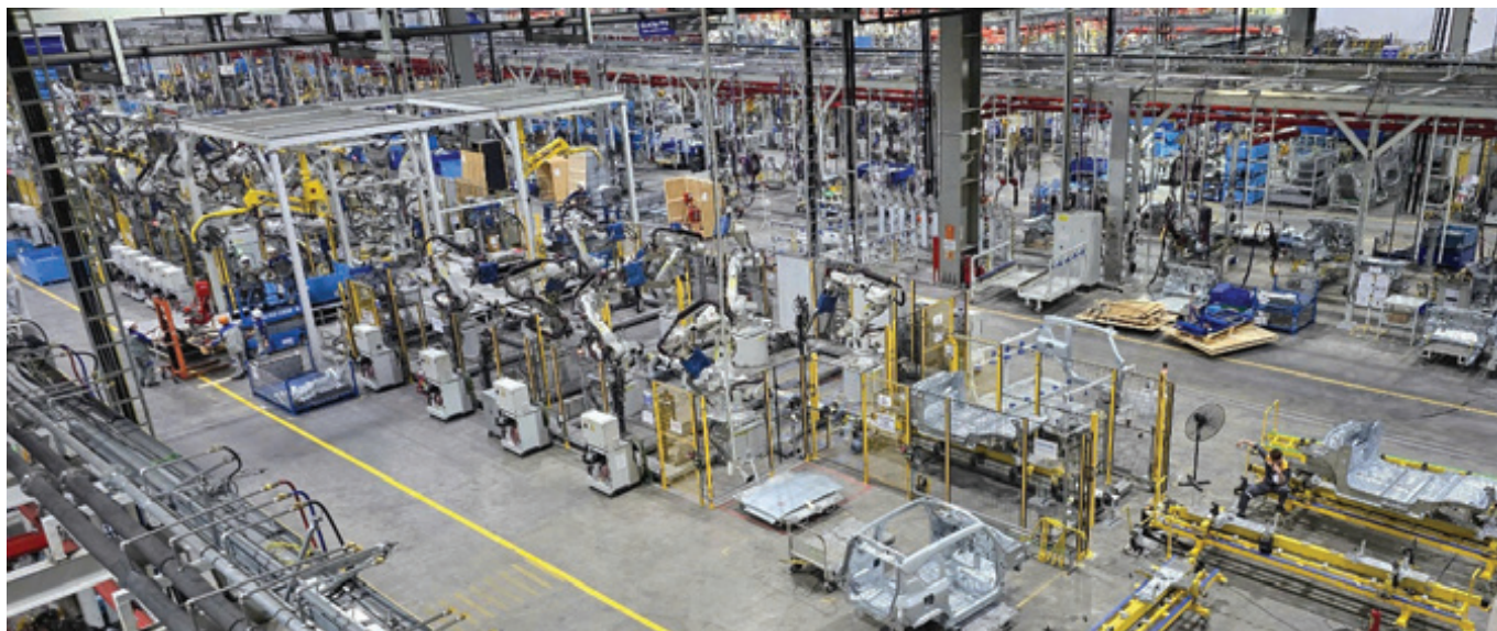
Dây chuyền công nghệ thiết bị, đồ gá hàn thân vỏ xe ô tô của VinFast do NARIME thiết kế, chế tạo, cung cấp, lắp đặt, hướng dẫn vận hành sản xuất.
