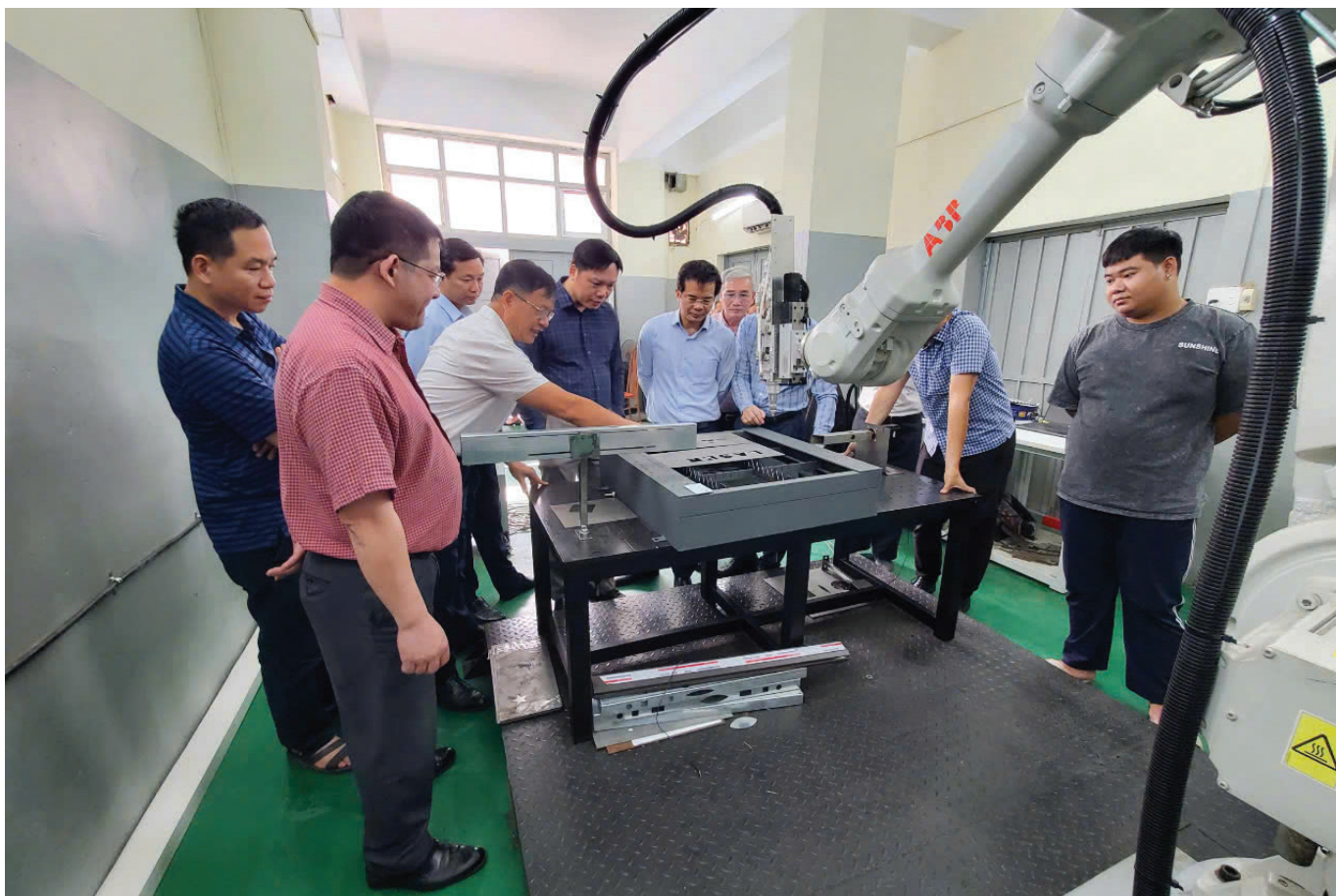
Kiểm tra thiết bị robot cắt kim loại sử dụng bức xạ fiber laser. Ảnh: NACENTECH.
